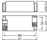
**Scheda tecnica Osram LED Driver Optotronic FIT 40/220-240/1A0 CS**
