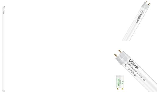
**Scheda tecnica Osram Tubo LED T8 SubstiTUBE Advanced (EM/Mains) Ultra Output 15.1W 2500lm - 840 Bianco Freddo | 120cm - Sostitutiva 36W**
