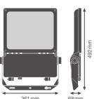
**Scheda tecnica Ledvance Proiettore LED Flex Bianca 130W 19800lm 45x140D - 840 Bianco Freddo | IP66 - Asimmetrico**
